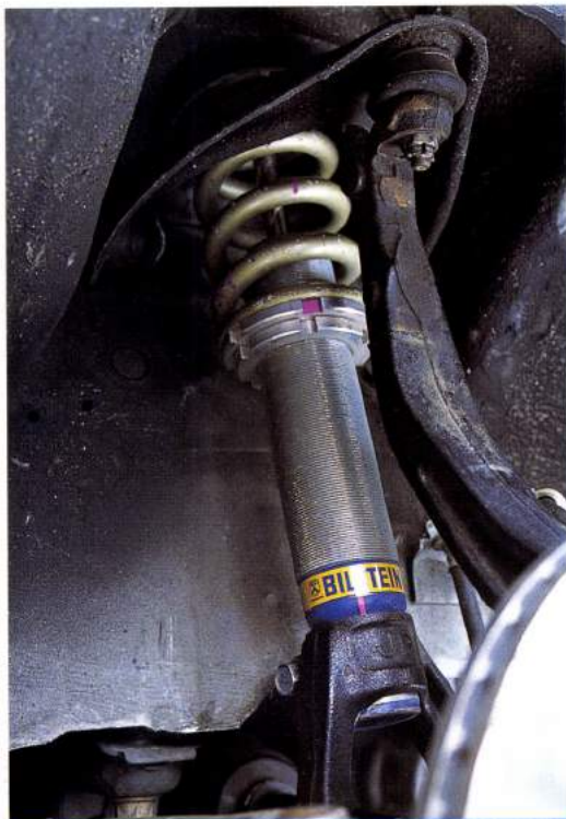
車高調はショック底部からロアシートまでの高さも把握しておく。これが4輪であまりバラつくともストローク量も変わってしまうからだ。
