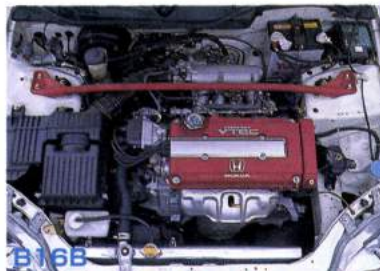
B16B 185ps/8200rpm 16.3kg-m/7500rpm
