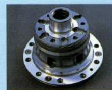
L.S.Dは2WAYよりも1WAYもしくは1.5WAYタイプの方が乗りやすい。また、入れるデフオイルによっても特性が変わってくる。
