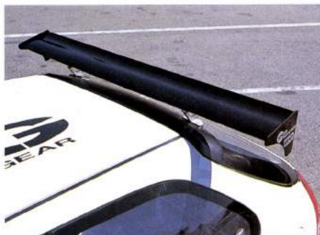
サーキットで即効性が高いGTウイング。テクノプロスピリッツ製など純正の穴を利用してボルトオン装着できるものもある。
