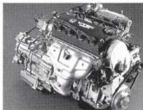
吸気側のバルブタイミングとリフト量を切り換えクラス最高の130psの最高出力と10モード燃費16.4km/ℓの低燃費を実現。
