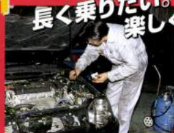
ブレーキオイル、エンジンオイル等潤滑油関係をチェック。クラッチフルード、パワーステアリング油も点検します。
