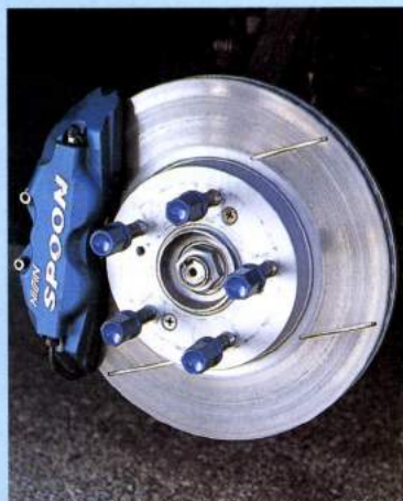
ブレーキは効き自体は十分だが、前後バランスを改善したい。アフターのキャリパーに交換する手もあり。
