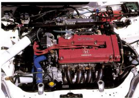
B20TCエンジンの秘密は、B20Bエンジンのブロックを使用してスクエアに近いボア×ストロークを確保したため。230ps仕様 (48万円) も設定ある。マフラーもオリジナル。
