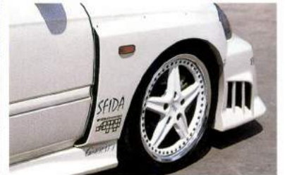
ホイールのリムはF7.5J、R7.0J。これに205/50-16のタイヤを履く。フェンダーのスリットは、走行風で右がエアクリナー、左がオイルクーラーを冷却する役割を果たす。
