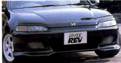
両サイド前方の突き出しを強調したフロントバンパースポイラー。開口部も大きく取られ、冷却効率という点でも文句なし。
