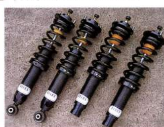
筑波サーキットで煮詰められたアルミシエルケース採用のオリジナル車高調サスキット。ピロアッパーマウントが付属となり、前後とも減衰力の12段階調整が可能。スプリングはF23、R18kg/mm。
