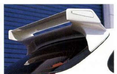
2段式となるリアウィングの装着により、高速コーナーで有効なリアダウンフォースを発生する。上段ウィングは角度調整式で、コースに合わせたセッティングも可能。
