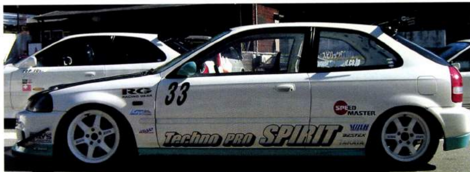
車高は真横から見てやや後下がりに見えるぐらいが、実は水平だったりする。ジャッキアップポイントを確認してみよう。
