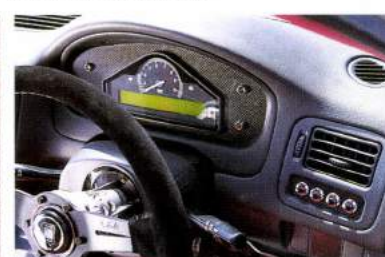
メーターはタコメーターだけというシンプルなスタックのマルチファンクションでレーシーな雰囲気。水温や油圧、車速等はグリーンディスプレイ上に表示される。
