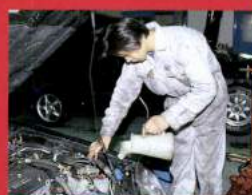
冷却水、ウォッシャー液等チェックしながら各種配管、配線に異常がないか点検。
