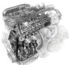
可変バルブタイミング&リフト機構搭載のB16A型が登場。ZC型と対照的にショートストロークタイプで160ps/15.5kg-mを発揮した。
