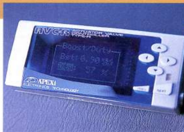
ターボ車と同じ考え方で、ブーストを上げるために使うというより、ブーストの上限を設定したり、安定させたりするために必要になる(写真はアベックスのAVC-R)。
