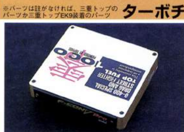
VTECターボの場合は負荷やインジェクターの問題でメインコンピュータで対応できず、基本的にフルコン、サブコンで対応することになり、セッティングが必要だ。
