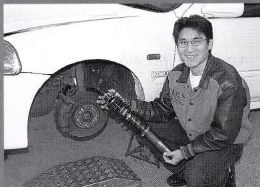
走りの消耗品の代表といえるサスペンション。オーバーホール可能なショックが装備されていたら性能もよみがえるぞ。
