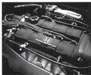
135ps/15.5kg-mを発揮する1.6LのZC型は、84年12月に3ドアSiに搭載された。ホンダ新世代DOHCの幕開けと評価されたエンジンだった。
