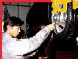
空気圧のチェックは勿論タイヤ・ホイールに損傷はないか前後のサイドウォールまでもレーサー同様のチェック。バルブ、ローター、キャリパー、ブレーキホースも全て点検。
