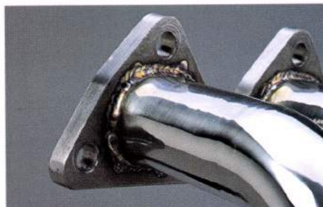
リューターによる研磨仕上げのポート部やマシニング加工のフランジ部が美しい仕上がりを見せる「4in1エキゾーストマニホールド」。徹底的に駄肉を削り、7.3kgという純正の約半分の重量を実現。
