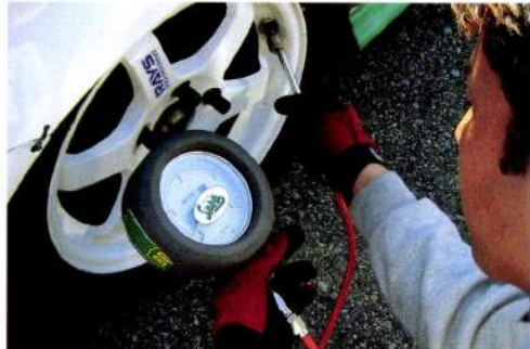
エアゲージはモノによって圧力表示にばらつきがある。なるべくきちんとした製品を選び、毎回同じゲージを使うようにした方が正確。
