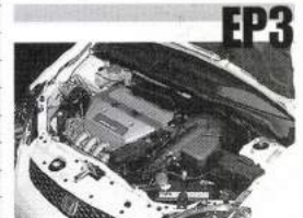
EP3 エンジンは2.0ℓのi-VTECを搭載。タイプR専用パーツを多用し8400回転まで軽やかに伸びる新世代ユニット。クロス化された6速ミッションを採用。
